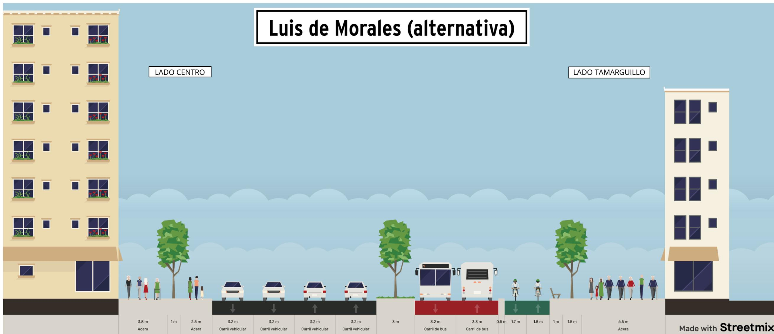
*Ilustración 4. Sección tipo alternativa propuesta por sevillsemueve para la Calle Luis de Morales. La calzada izquierda permanecería inalterada de bordillo a bordillo, y en la derecha solo necesitaría ampliarse a través del actual carril bici, que se mejora desplazándose al otro lado de la calle.*
