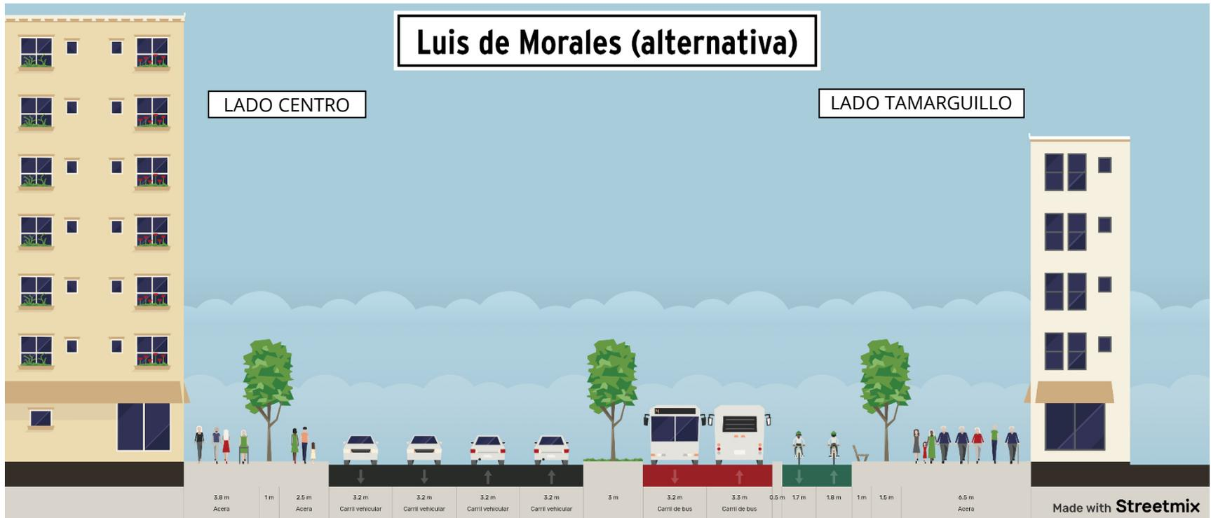
*Ilustración 10. Sección tipo alternativa propuesta por sevillsemueve para la Calle Luis de Morales. La calzada izquierda permanecería inalterada de bordillo a bordillo, y en la derecha solo necesitaría ampliarse a través del actual carril bici, que se mejora desplazándose al otro lado de la calle.*
